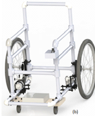
Fig. 1- Diseño en 3D del prototipo (a) con motores de competición de sumo-robot y (b) con motores de limpiaparabrisas
